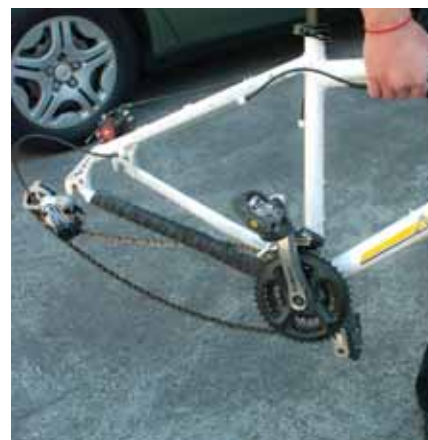
Quitarle la llanta trasera a una bicicleta tiene su grado de dificultad. Procura tener un trapo para limpiarte las manos después de la maniobra.
